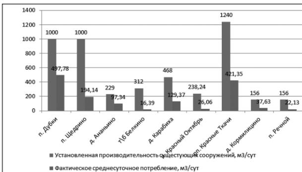
Как видно из диаграммы и таблицы, существующие водозаборные сооружения работают на пределе своих производственных мощностей (расчеты производились для работы насосов 24 часа в сутки), поэтому существует дефицит мощности водозаборных узлов. Высокое водопотребление связано с бесконтрольным поливом, потерями в сетях и неучтенным водопотреблением абонентов холодного водоснабжения Карабихского СП.
