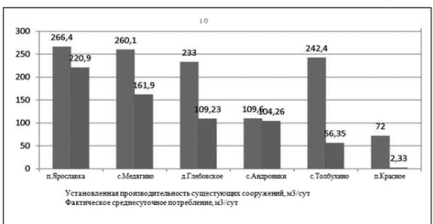
Как видно из диаграммы и таблицы, существующие водозаборные сооружения работают на пределе своих производственных мощностей (расчеты производились для работы насосов 24 часа в сутки), поэтому существует дефицит мощности водозаборных узлов. Высокое водопотребление связано с бесконтрольным поливом и неучтенным водопотреблением абонентов холодного водоснабжения Кузнецкого СП.
