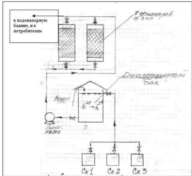
Рисунок 1. Принципиальная схема подачи воды в п/о «Ярославль»
