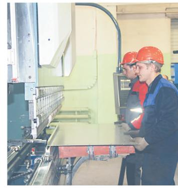
Новый гибочный шестиметровый станок в работе
